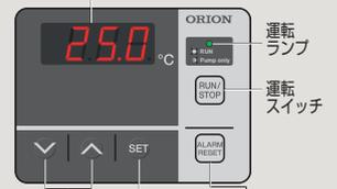
温度調節スイッチ 設定スイッチ リセットスイッチ
